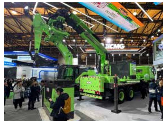
XCMG har utviklet et system hvor flere maskiner bruker samme batteritype og som enkelt kan byttes i stedet for at maskinen skal stå stille i lengre tid for å lade. Batteriene transporteres på en lastebil som er utstyrt med kran, og selve batteribytting skal kunne gjøres på 15 minutter. Batteriet kan blant annet brukes på beltegraveren XE215EV (22 tonn), hjullasteren XC968-EV (ca. 22 tonn) og dumperbilen EHSF3FI.
