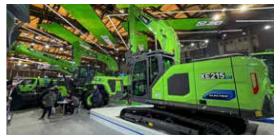
XE215EV (22,5 tonn) var største batterielektriske beltegraver på XCMGs stand. Ifølge selskapets nettside har de også modellen XE270EV (27,5 tonn), men den var ikke å se på messen.
