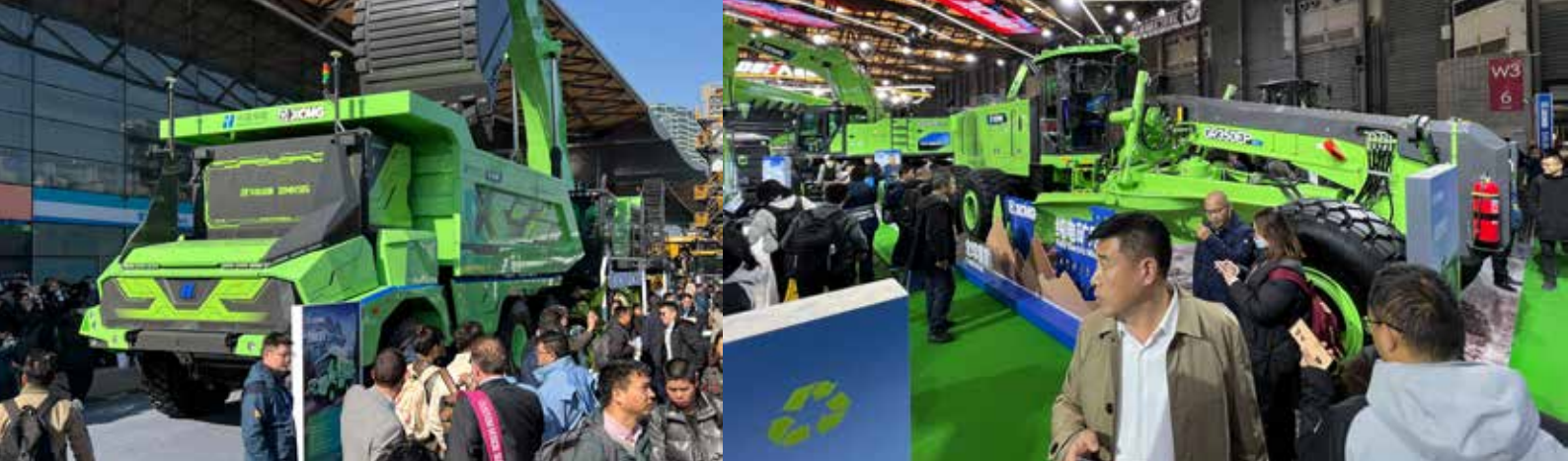
ZNK95 er en batterielektrisk autonom tipptruck med 85 tonn nyttelast. Den er utstyrt med et utskiftbart batteri på 509 kWh.
