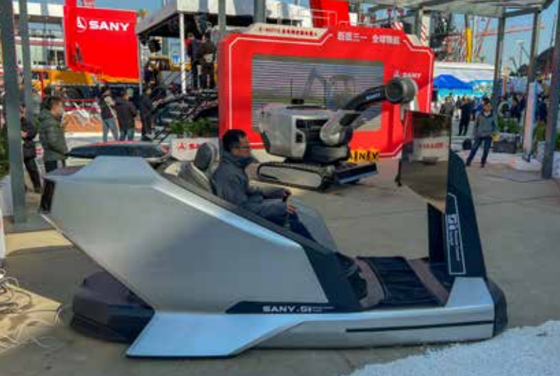
E-MOVE er en fjernstyrt minigraver med helelektrisk drivlinje og aktuatorer. «Romskipet» maskinføreren opererer minigraveren fra en studie i seg selv.
