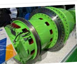
XCMG har egen batteri- og el-motorfabrikk, og presenterte også dette på standen. ERL460R96 er en elektrisk drivenhet med høyt dreiemoment, eller enklere forklart – drivaksel med integrert el-motor for bruk på hjullastere.
