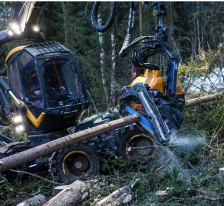
AUTOMATISK: Hogstaggregatet måler automatisk både tykkelsen på treet og lengden. Hogstmaskinfører Mathias Emilsson trykker på en knapp når det er tid for å sage.
