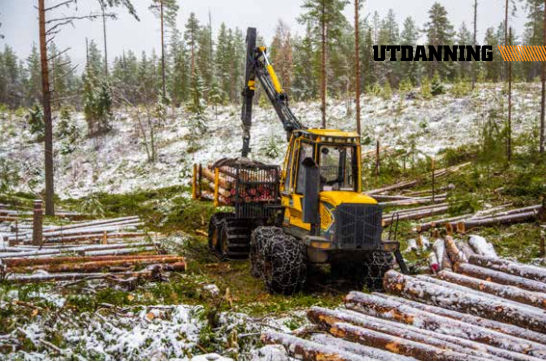
DYRT: Ett hogstlag, med en hogstmaskin og en lassbærer, koster åtte millioner kroner, bare for maskinene. Det stilles derfor strenge krav til produksjon. Her er en lassbærer i aksjon.
