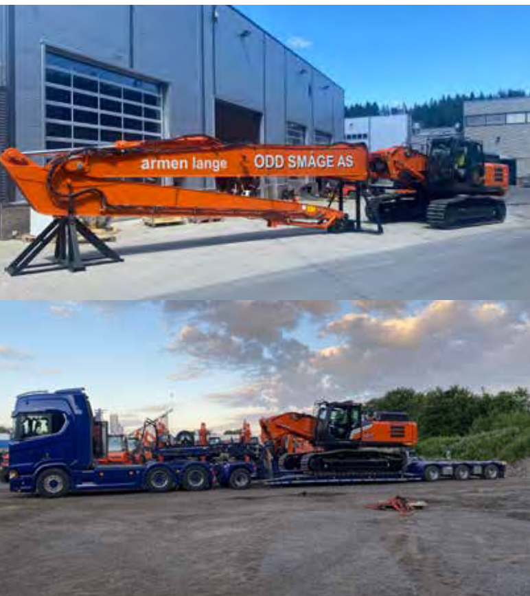
HK-FESTE: Et Oilquick 120 HK-feste på bommen er nøkkelen i løsningen. (Foto: Odd Småge AS)
