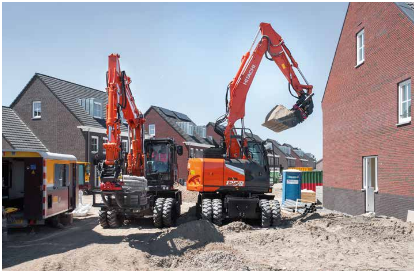
(hitachi_hjulgravere_7) 7-SERIE: Korthekkeren ZX135W-7 (t.h.) er nå den minste Hitachi hjulgravere. Den er basert på den større ZX155W-7 (t.v.) med konvensjonell hekk. De to har blant annet samme motor. Korthekkeren har en 360 graders svingradius på drøyt 1,7 meter for trange arbeidsplasser. (Foto: Produsenten)
