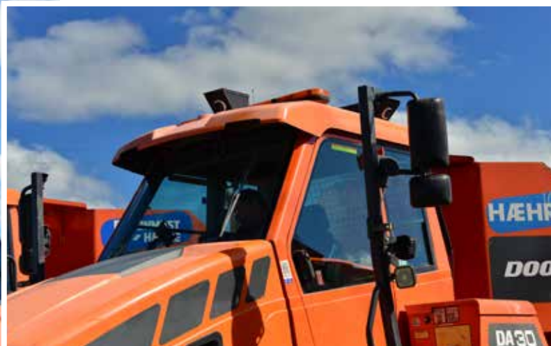
PÅ TAKET: Overvåking med kamera og bevegelsessensorer monteres på maskin.
