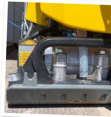
BUNNPLATE: Helt ny bunnplate, med innebygget sprinkler.
