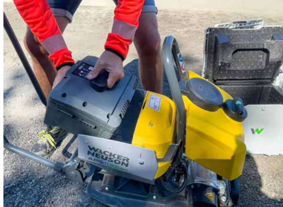
BATTERI: To størrelser, på hhv 1000 og 1400 wattimer. Eller hhv 20 og 28 amperetimer, regnet etter 51V spenning. Batteriet er så stort at det kommer i en egen ADR-godkjent kasse.
