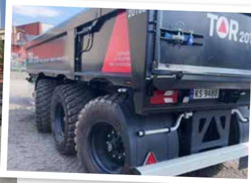
SVING: Hengeren har løft på første aksel og medsporing på første og tredje.
