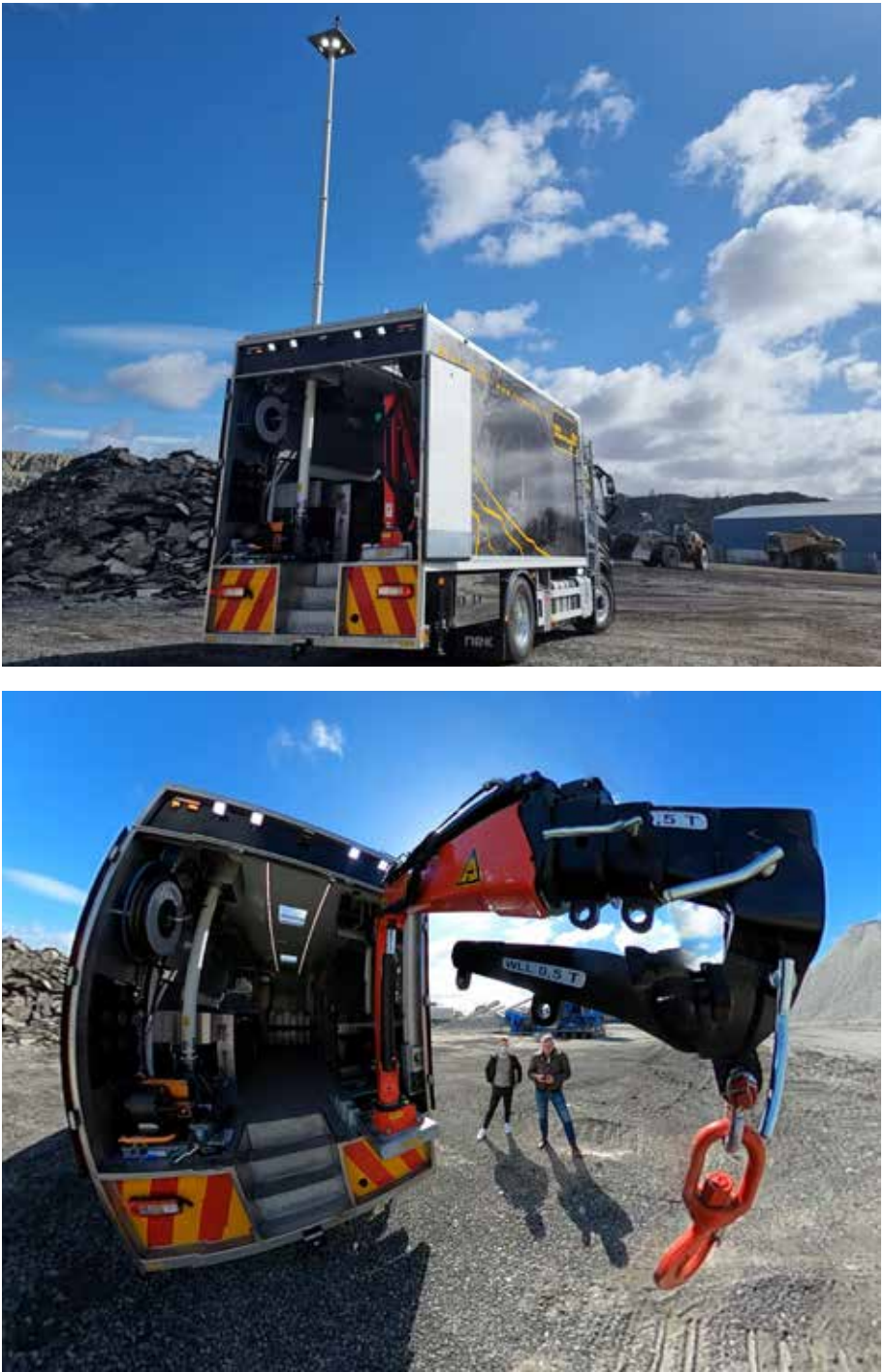
LYS: Seks kraftige lamper, åtte meter over tak. Lyser opp hele bruddet, om nødvendig.
