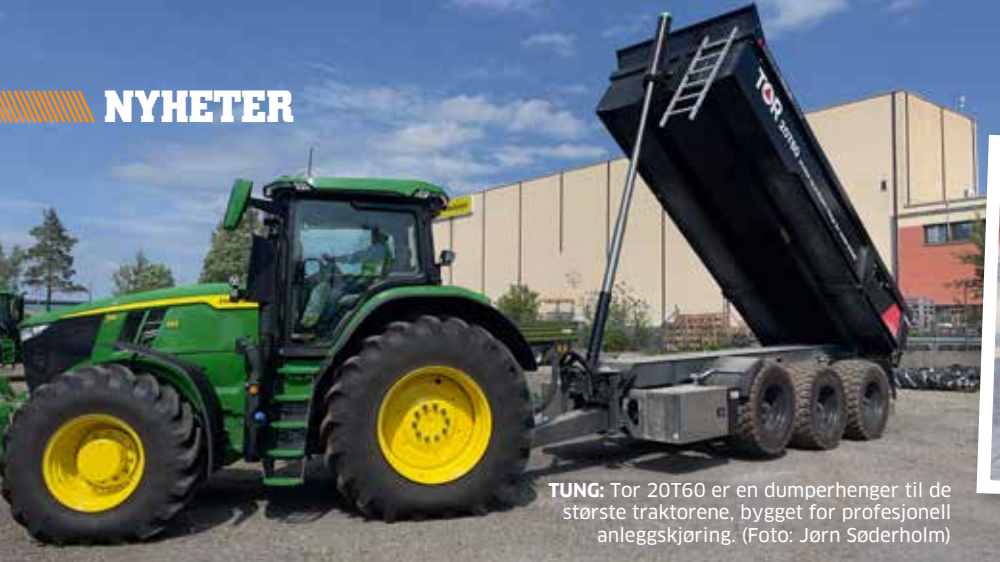
SVING: Hengeren har løft på første aksel og medsporing på første og tredje.
