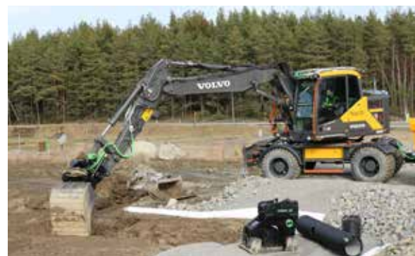
AUTOMATISK: Volvo kan nå fabrikkmonteres med Steelwrist SQ automatfeste.
