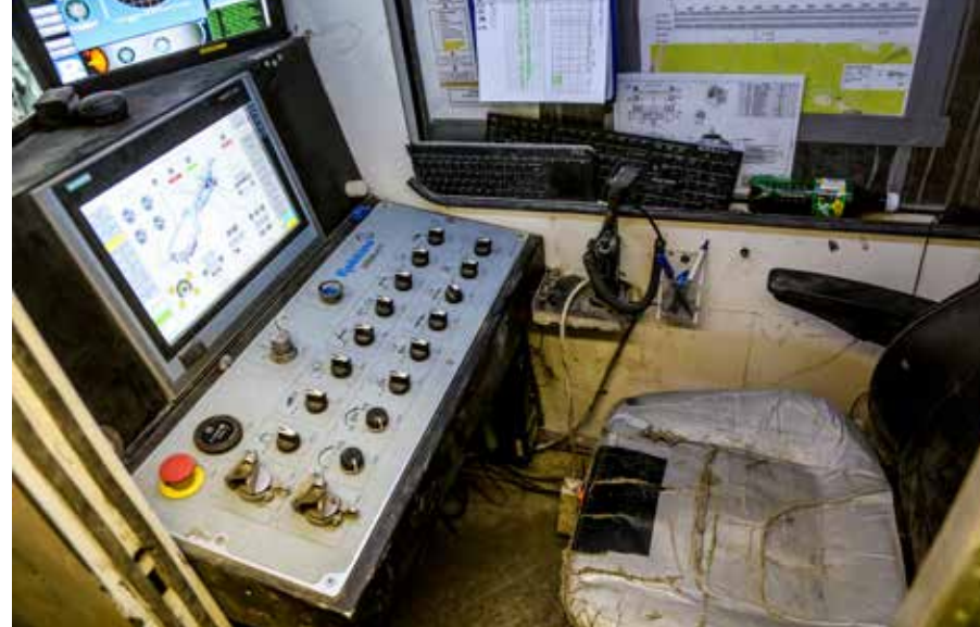
FØREPLASSEN: En av de 12 vognene på «TBM-toget» inneholder pilotkabinen, der man sitter og styrer hele showet.
