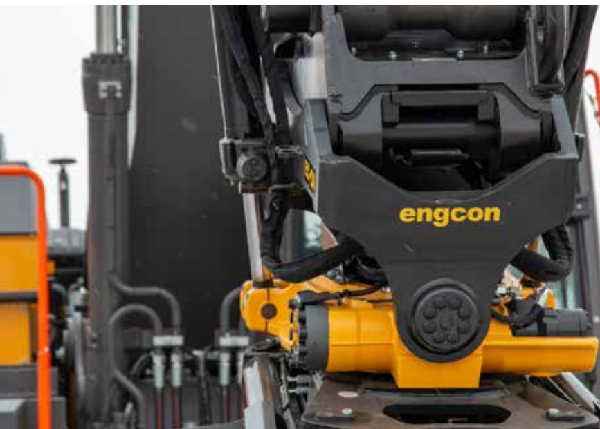
INTEGRERT: Det blir enklere å velge merke på tilten på maskiner med Volvos nye Smart Connect styringssystem. Det gjelder i første omgang oppgraderte EC250 og 300.
