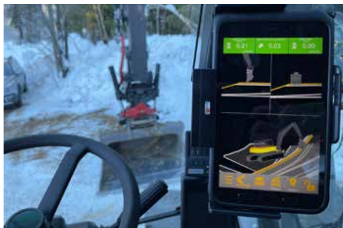
ENKELT: Nytt 3D gravesystem fra L5 Navigation og danske Unicontrol. Bildet er en montasje. (Foto: Leverandøren)
