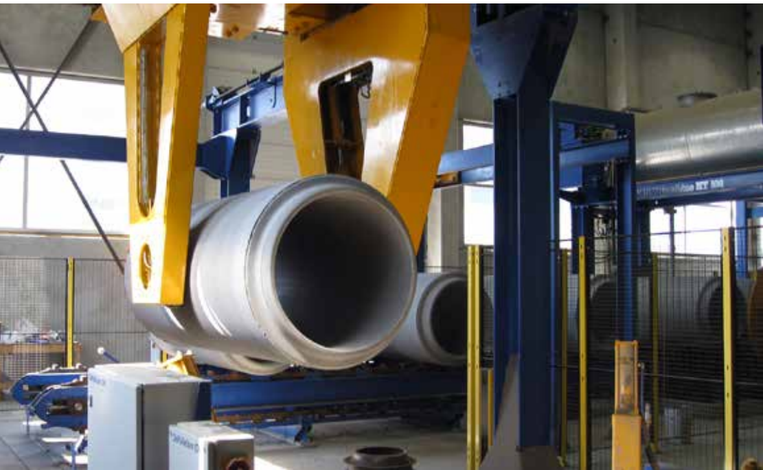
RØR: Betongrør på vei ut av maskinen hos Loe Rørprodukter AS. (Foto: Loe)
