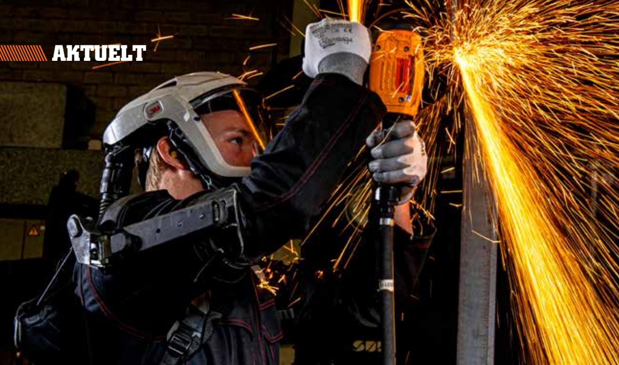
TESTER: Fem større entreprenørselskaper prøver nå ut en ny «ryggskinne», som med fjæring og mekanisk overføring sørger for å avlaste muskulaturen i armene når det arbeides med hendene over skulderhøyde.
