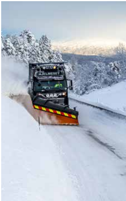
SMALT: Plogen er bare 330 på slitestålet.. Bredere er det ikke plass til på den smale veien.
