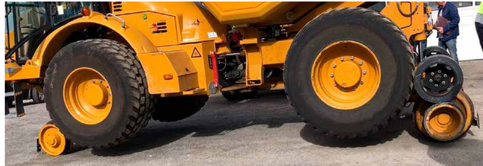
VANLIG: Hydrema har levert mange slike dumpere med jernbaneunderstell.
