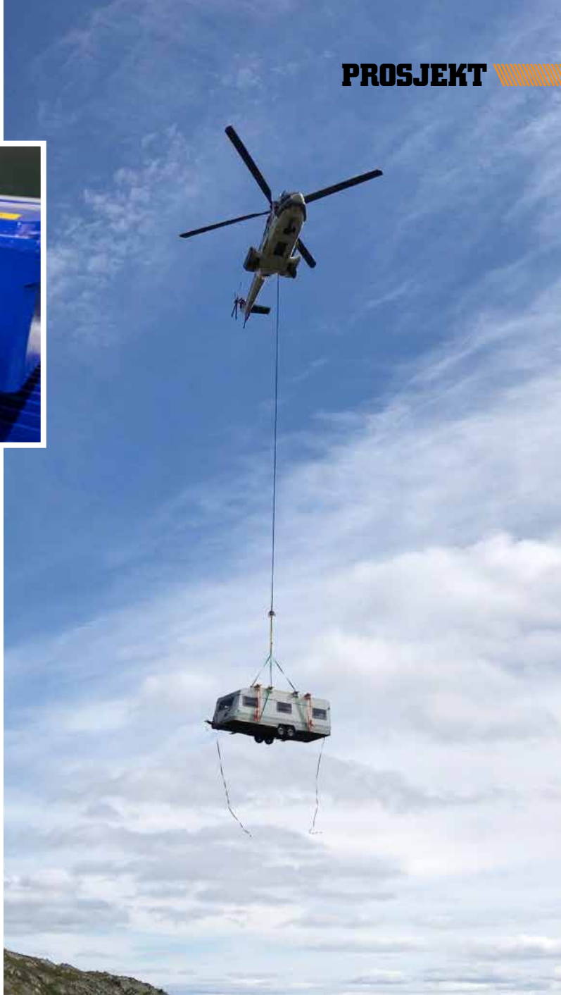
LØFT: Maskiner og utstyr ble løftet inn på fjellet med en Super Puma. (Foto: Alseth)
