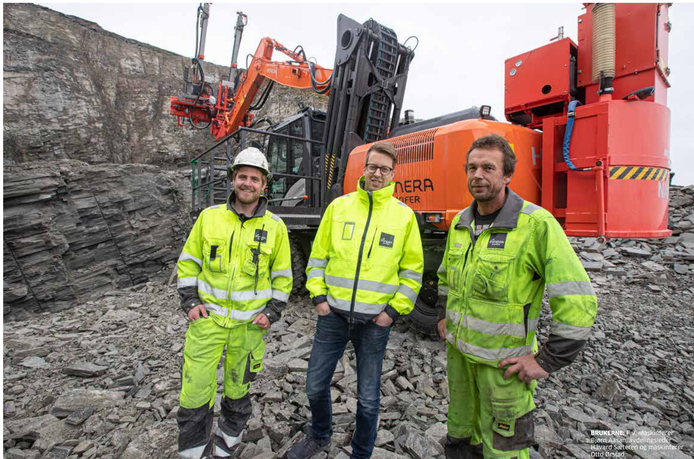
HYTTELØFT: Føreren kan gå rett inn på pallen fra den løftede hytta. Sparer tid på å slippe å bygge trapp.
