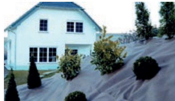
Bark/planteduken sørger for at plantene får vann og næring, og stopper samtidig ugresset fra å vokse opp fra undersiden.
