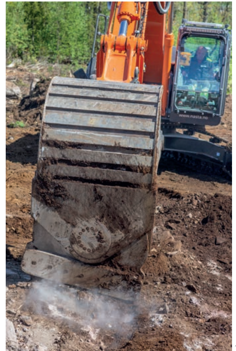
SKUFFE: Fjellrensk kan være hardt for tiltrotator. Dette er en spesialskuff for fjellrensk.
