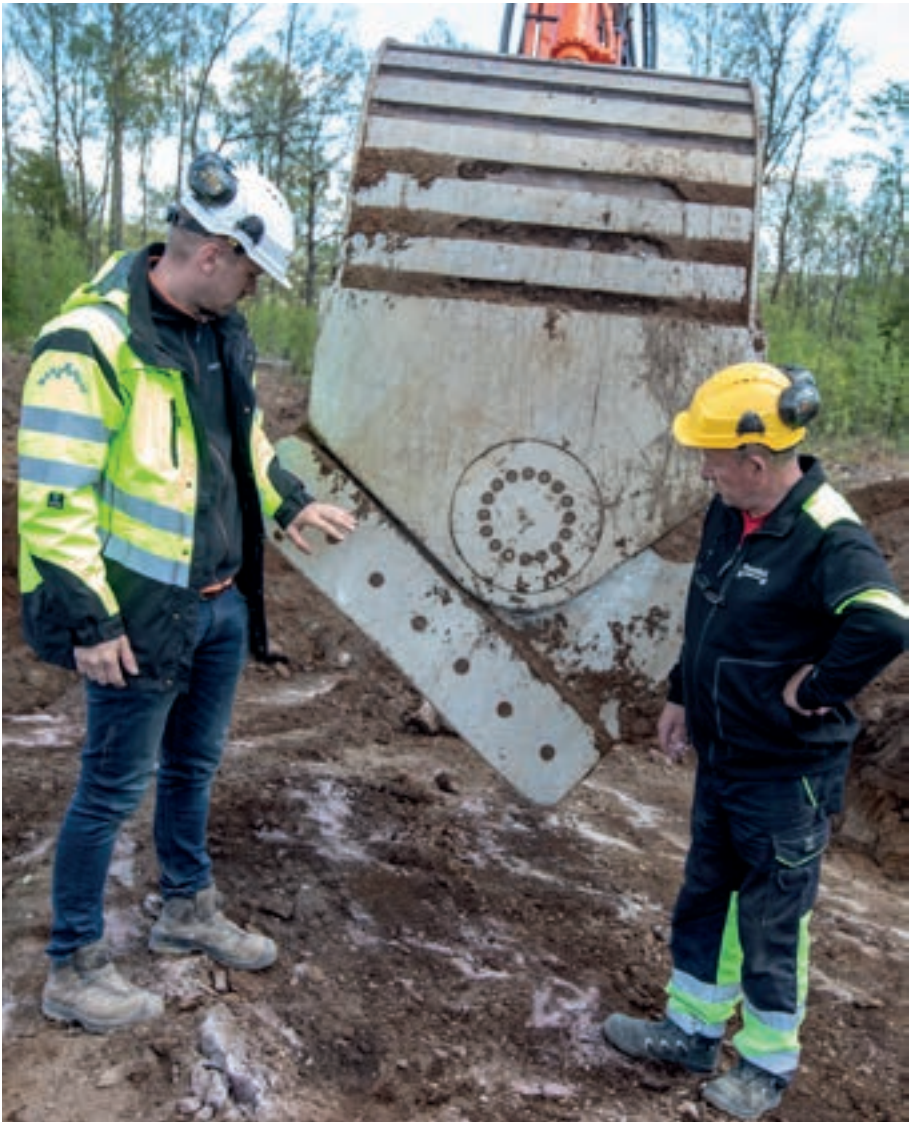
SKJÆR: Renskeskuffen fra Götene UFO har dreibart skjær. Ole-Kristian Bonstad (t.v.) orienterer Morten Bergan.
