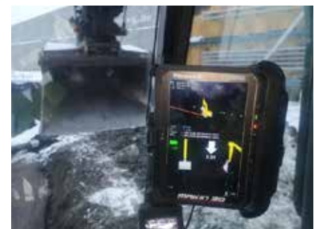
SKJERM: Slik ser Makin3D ut, operativt i hytta. (FOTO: LEVERANDØR / MASKINFØRER)
