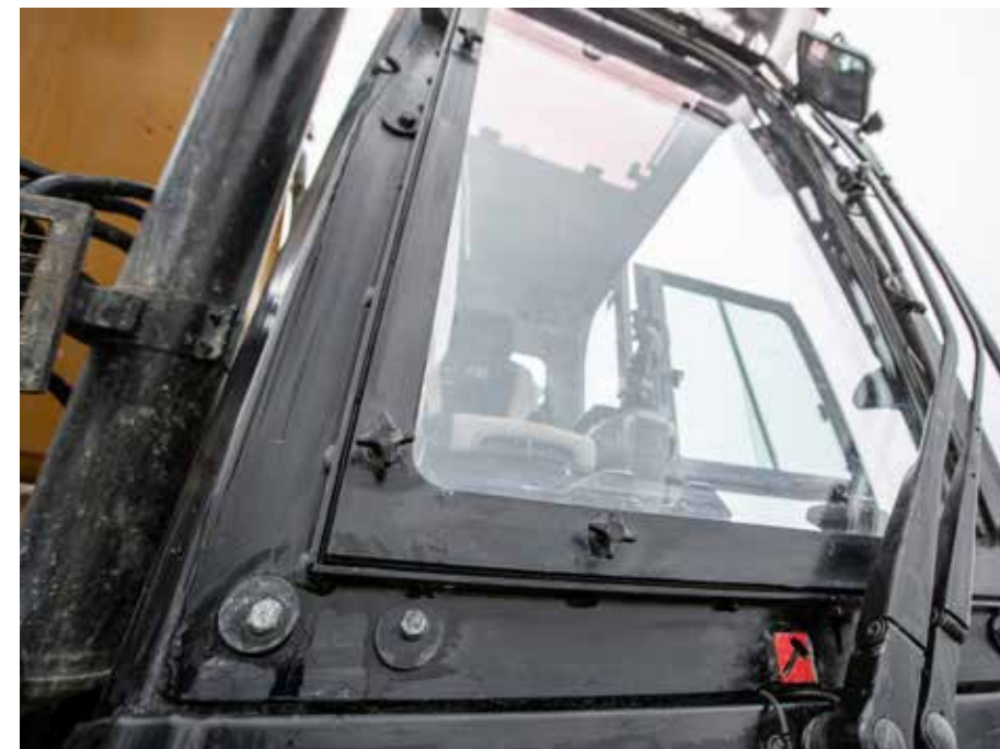
RABS: Dette er en RABS-godkjent frontrute. Maskinen må i tillegg ha 8 mm sikkerhetsglass i alle andre vinduer for å oppfylle kravet til verneklasse 3.
