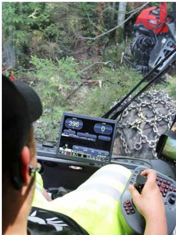
AVANSERT: Hogstmaskiner registrerer gjerne i sanntid alle data om tømmerstokken som hogges, samtidig som GPS-en kombinert med karttjenester registrerer nøyaktig hvor maskinen befinner seg til enhver tid.
