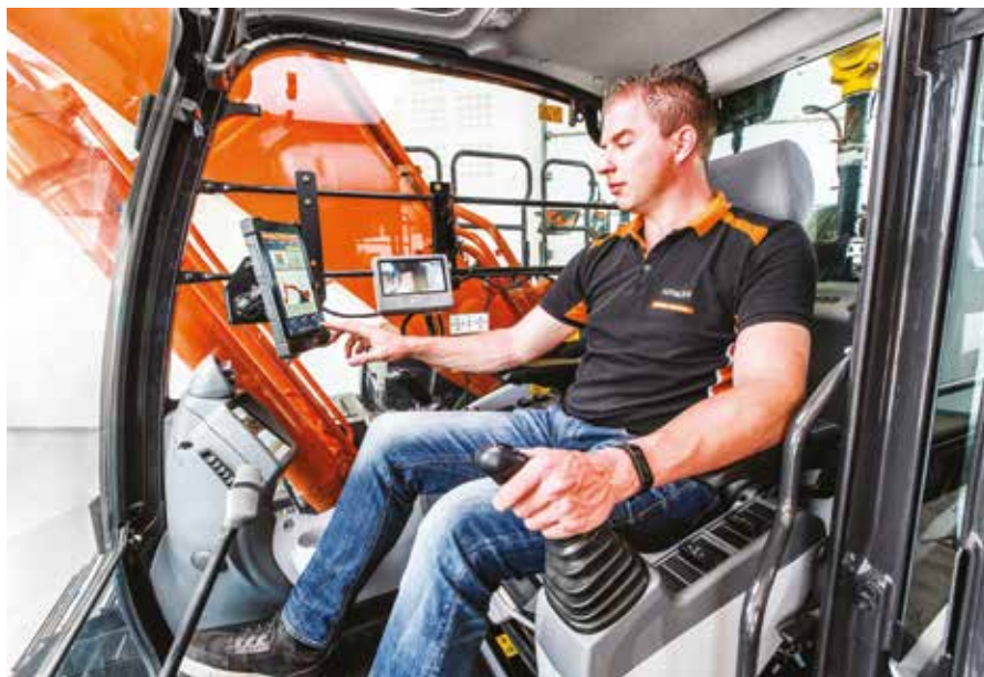
AUTOMATISK: Hitachis nye 210 ITC har både 3D og assist. (Foto: Hitachi)
