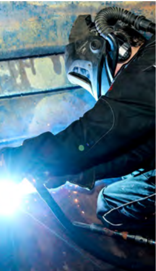
HEI SVEIS: Lærling Asle Staven sveiser på en stor gravemaskinskuffe på verkstedet.
