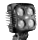
LED-arbeidslys, 40W 9-50V, 3800lm, EMC-godkjent CIPSR 25, kabel 1,5m med DT-kontakt. Mål: 105x105(138)x64mm
