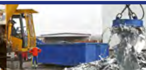
Lyftmagnet LM1300 Hantering av järnskrot
