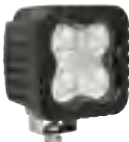
LED-arbeidslys, 60W 12-48V, 5400lm, EMC-godkjent, integert DT-kontakt, IP67 Mål: 110x110(132)x84mm
