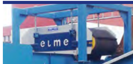
Magnetseparator MS1000S1200 Separering av järn
