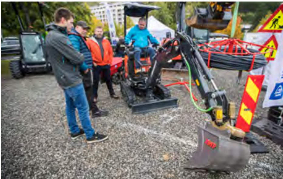
TILT: Dette er en Steelswrist TMX, et enkelt tilt-feste for de minste gravemaskinene. For bæremaskin 700kg-4000kg, med S30 og S40. Ingen rotasjon, men gjør det mulig å tilte alle redskap. Kompakt slangeføring er det også på den. Tiltet står på en Eurocomach ES12ZT fra Vinge Maskin.
