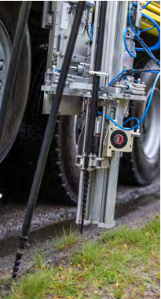
SKRUR: Den spisse, gjengede enden av stikka skrur ned i bakken.
