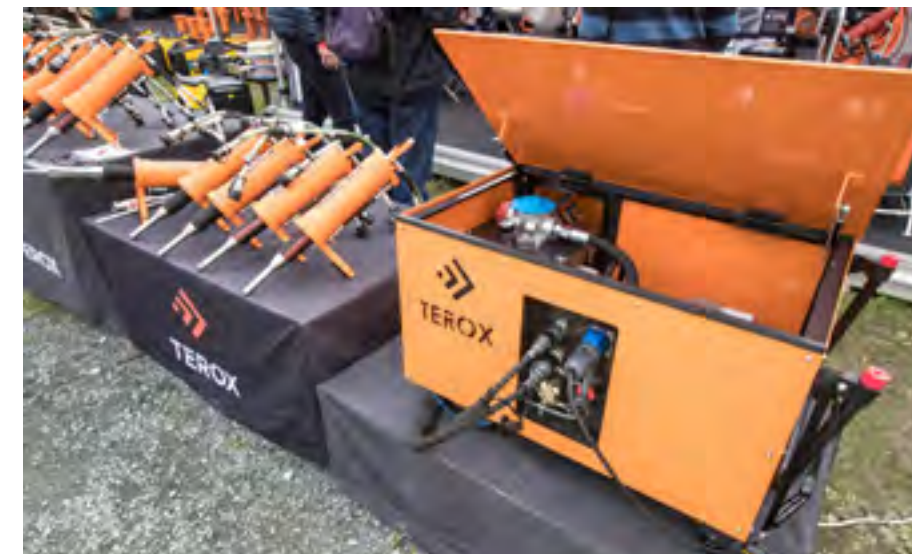
HYDRAULIKK: Terox AS har laget sitt eget hydraulikkaggregat til håndholdte splittere. Leverer 6,9 l/min ved 220 bar, og kan fint forsyne opptil 8-10 splittere koblet i serie.
