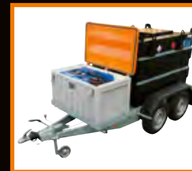
200 L AdBlue i isolert kasse med varme
