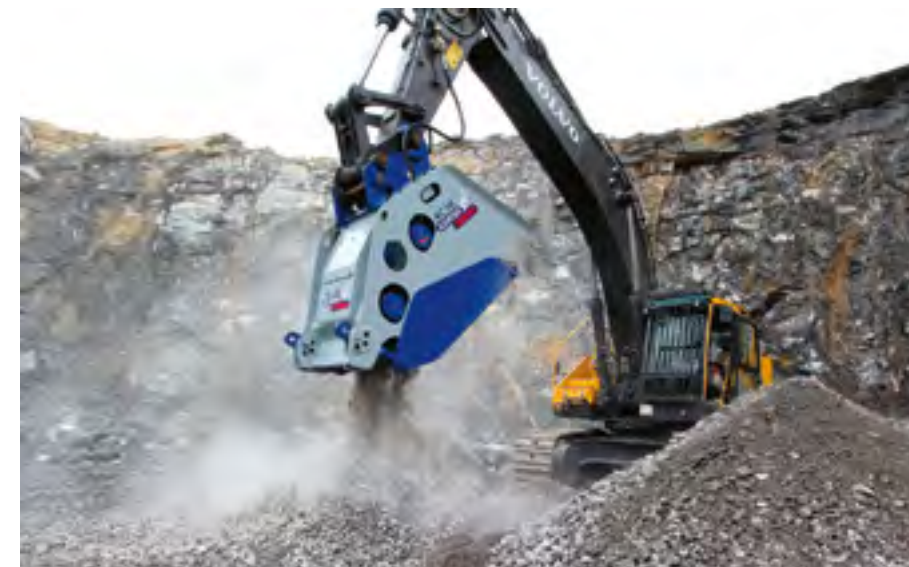
KNUSER: Xcentric leverer også knuseskuffer til store maskiner.
