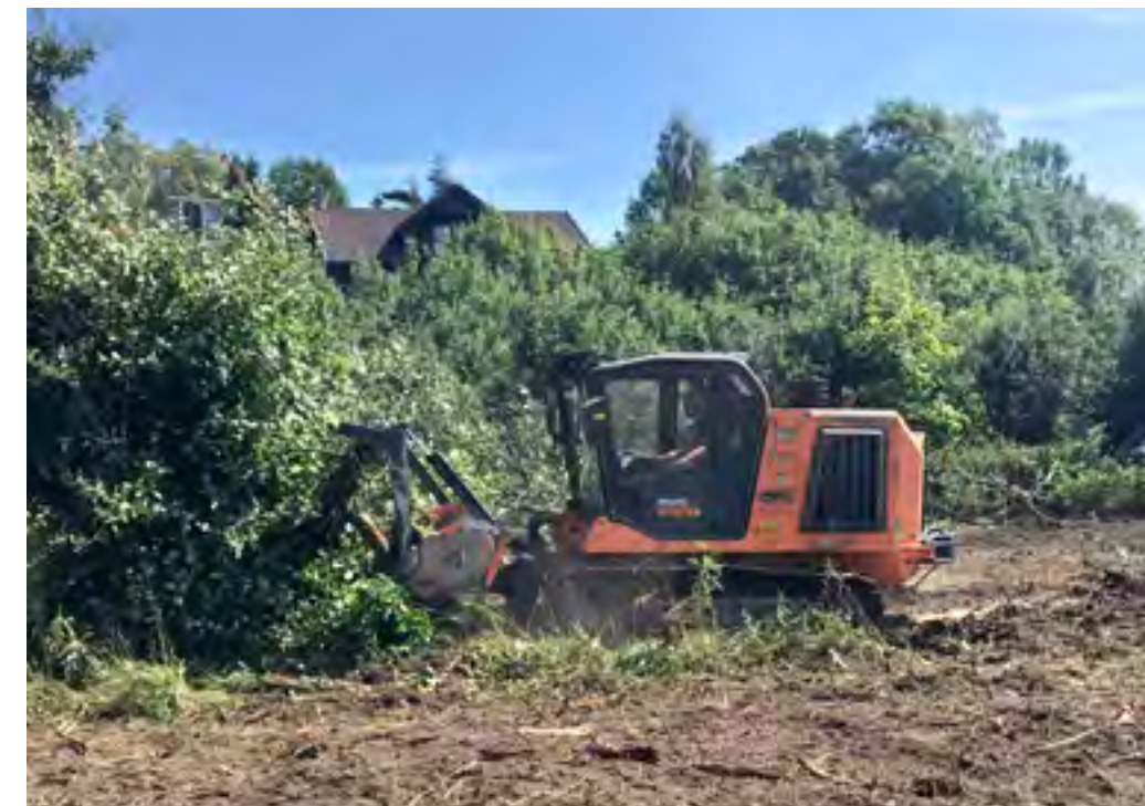
FRESER: Prime Tech er en serie beltegående maskiner som bærer fresehoder til det meste.
