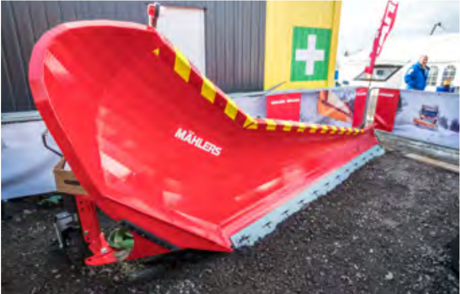
SIDEPLOG: Utkastet er bygget om. Den nye versjonen av Mählers SPH skal kaste høyere, for å unngå bygging av skavler.
