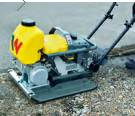
BATTERI: Wacker Neuson AP1850e, 100 kilos vibroplate på batteri.
