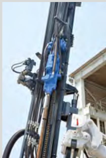
DEMPER: ExcaDrill boretårn, nå med Furukawa drifter i HD 700-serien.
