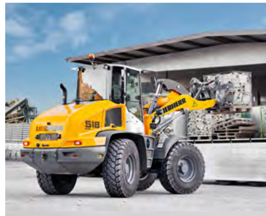
STEREO: Liebherr L518 Stereo, med midjestyring og sving på bakre aksel.
