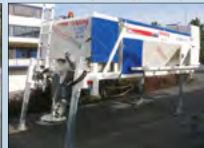
Varmtvannsbefuktning av salt (HighEnergySalting)
