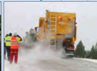
Varmtvannsbefuktning av salt og sand (Fastsand)
