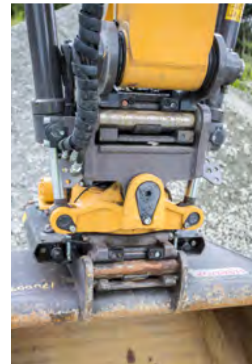
ENHETLIG: Den nye Cat M317F-en har SMP Hardlock både over og under tilten.
