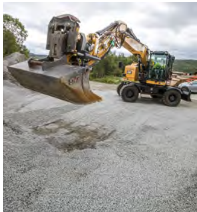
LÅST: – 100 prosent sikret mot å miste skuffa, sier Pon Equipments produksjef om SMP Hardlock redskapsfeste.
