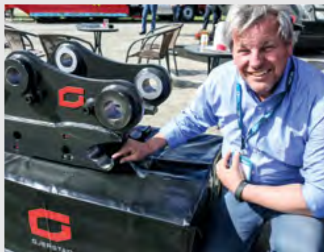
SecurityLip: Stig Kjetil Haugsvær i Gjerstad Products AS peker på «sikkerhetsleppa».
