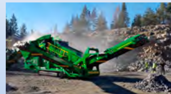
Sikteverk inntil 4 fraksjoner
