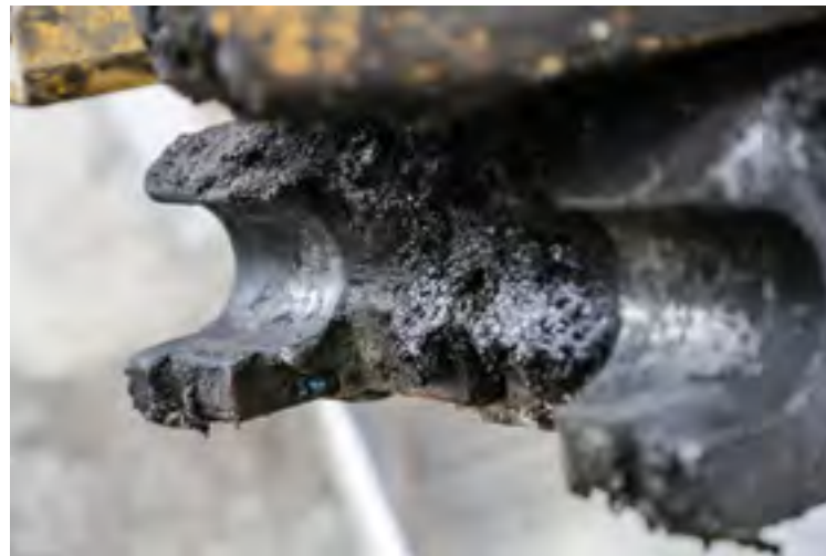
PLASTIKK: Indikatorpinnen nede til venstre viser at HK-festet er åpnet. Litt dumt at den er av plastikk og dermed har brukket under arbeid. I tillegg blir den fort så møkkete at den ikke synes veldig godt.
