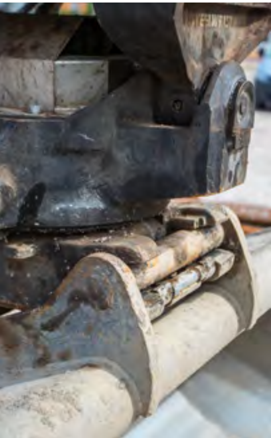
LÅS: Et par fjærbelastede låseklakker smetter seg rundt forakslingen. Hindrer skuffa i å falle av dersom låsekilden på den andre akslingen i HK-festet ikke går riktig i lås.
