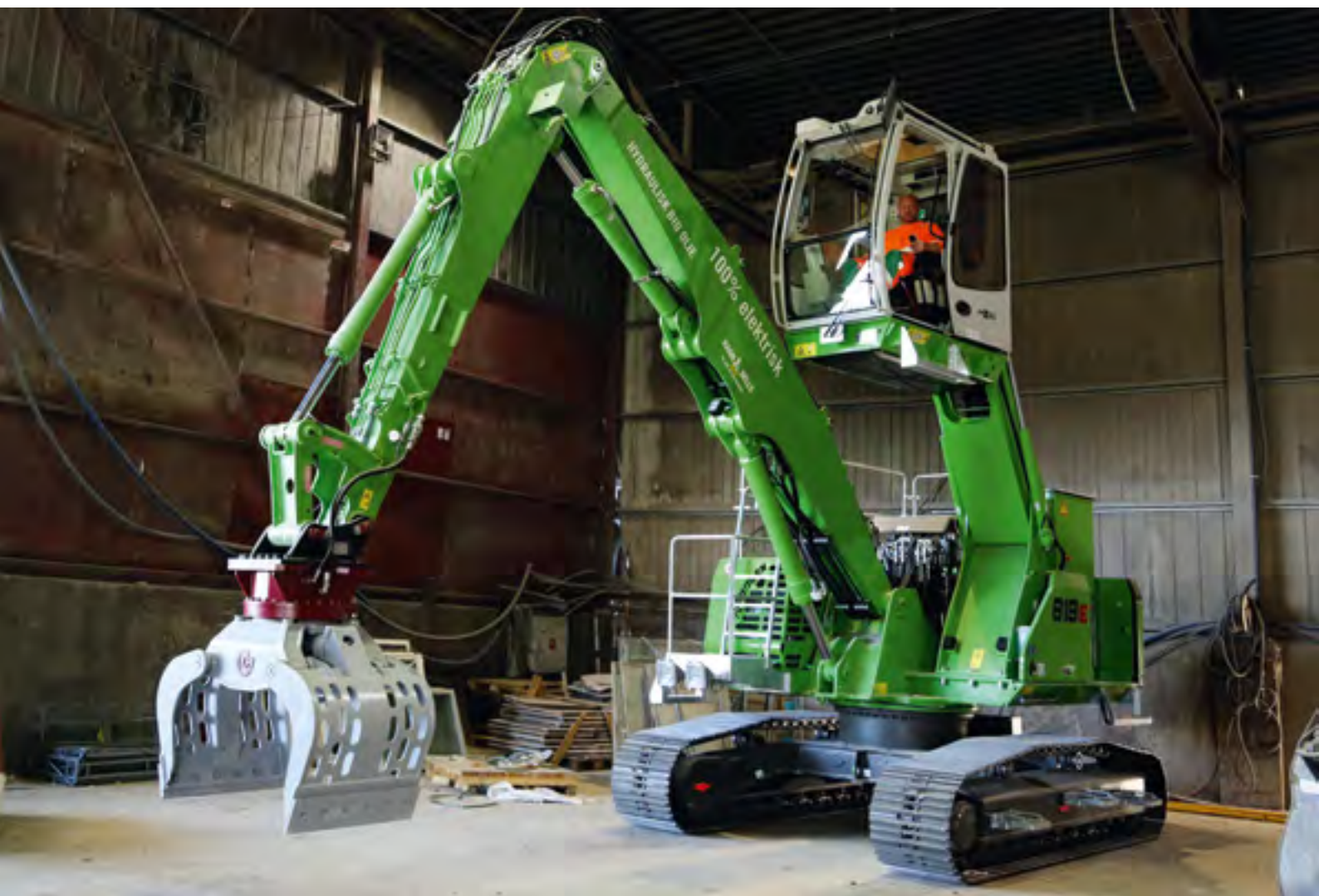
GRØNN, MEN STASJONÆR: Norges første helelektriske sorteringsmaskin, en 20-tonns Sennebogen 818RE, ble levert til Ragn-Sells på Lørenskog i fjor. Den er imidlertid avhengig av en strømkabel og mobiliteten er dermed begrenset. Hvor lang tid vil det ta før vi har kun el-maskiner på anleggsplassene våre? Vil det i det hele tatt la seg gjøre?
