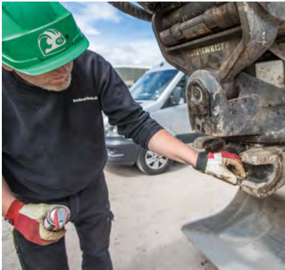
SMØRE: Låseklakkene trenger ettersyn. De er ikke en del av sentralsmøringen, men trenger en dæsj av og til for å fungere riktig.
