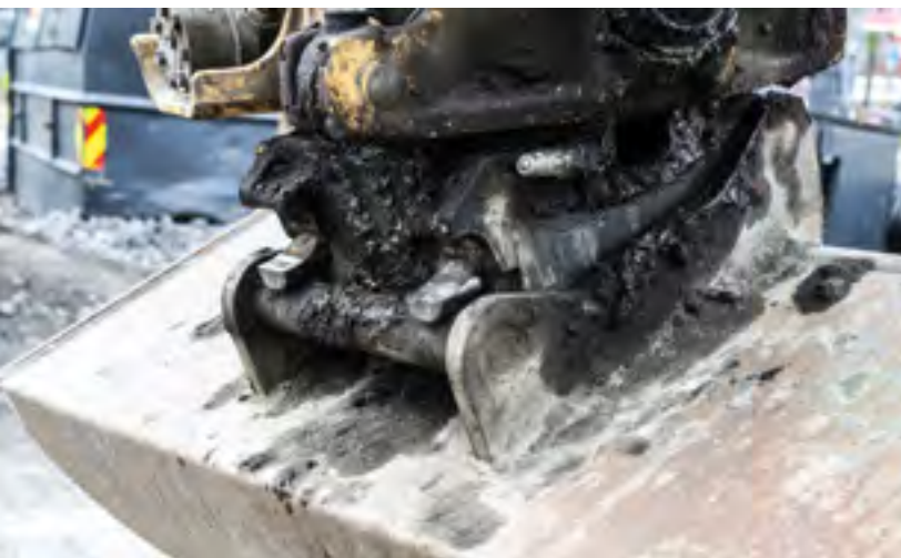
VISUELL KONTROLL: Selv om indikatorpinnen viser at skuffen er låst, bør man snu skuffen og sjekke at det ser riktig ut. Det gjør det ikke her!
