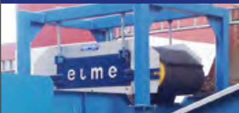
Magnetseparator MS1000S1200 Separering av järn
