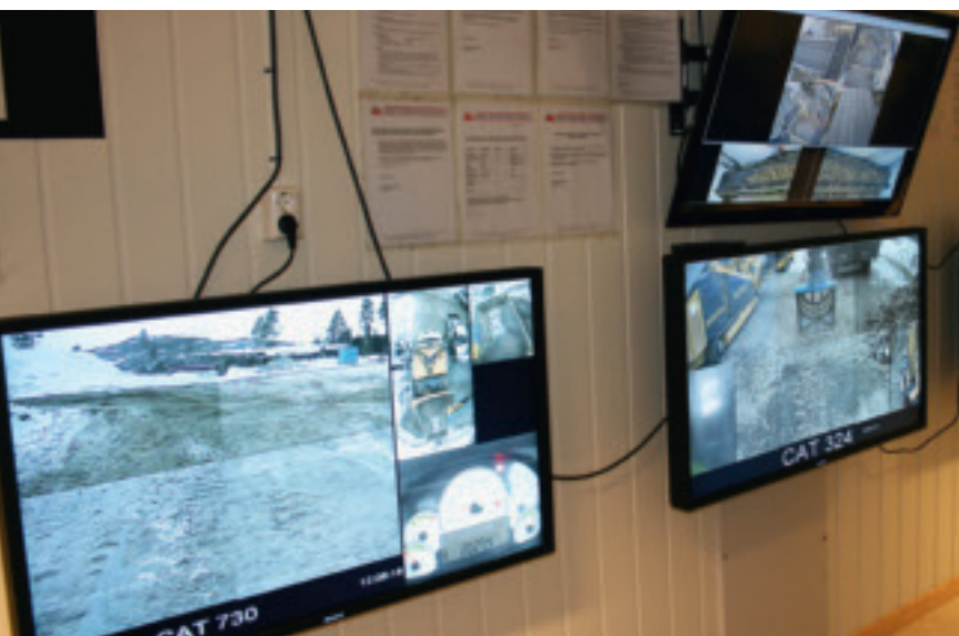
42 tommer I en liten container noen hundre meter fra deponiet sitter maskinførerne og styrer ”spøkelsesmaskinene” ved hjelp av pedaler og spaker og flatskjermer på veggen.
