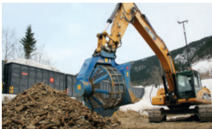
Sil Den første grovsorteringen gjøres med en spesialsuffe, som fungerer som en slags sil; alt som er større enn fem centimeter blir værende igjen i skuffen.
