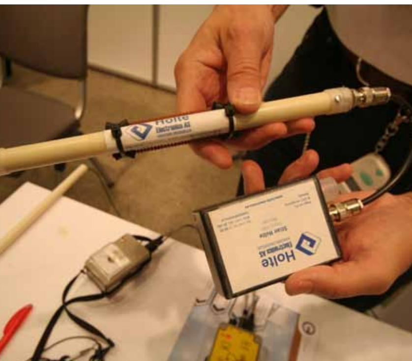
Prototyp Holte Electronics med prototyp som virker. Siganlgeneratoren er tenkt brukt sammen med fra før kjente Cablebuster.
