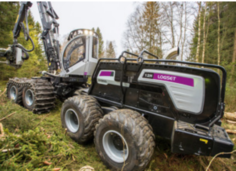
HYBRID: Overskuddsenergi lades inn i tre kondensatorer.
