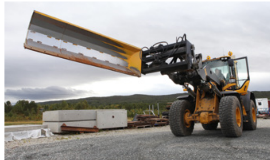
Her er plogvingen som brukes til å fjerne snø langt ut på siden av veien. Denne har Skotts maskin selv laget.
