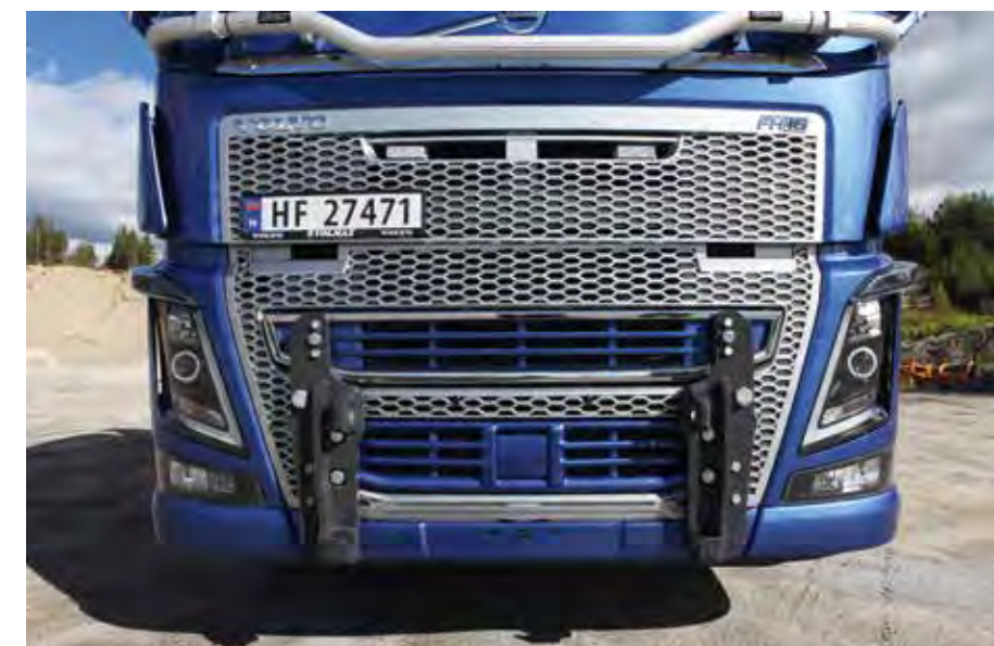
Den nye lastebilen har en ny type plogfeste, som er utviklet av Mählers i samarbeid med Volvo. Radaren er plassert bak et deksel mellom festene.
