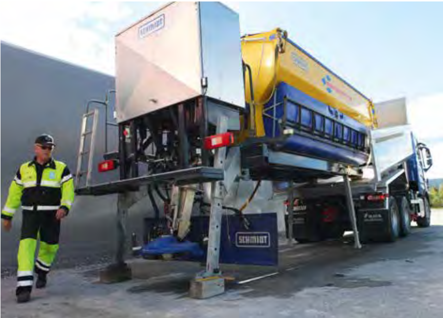
Saltbalja med fastsandspreder skyves inn på lasteplanet på den nye lastebilen til Leif Sturla Lillestrøm.
