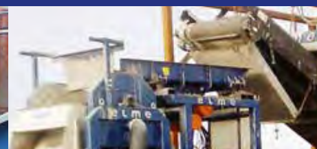
Virvelströmsseparator VS1200 Separering av alu, koppar, zink...
