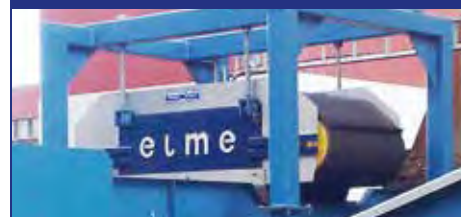
Magnetseparator MS1000S1200 Separering av järn
