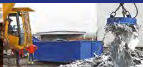
Lyftmagnet LM1300 Hantering av järnskrot
