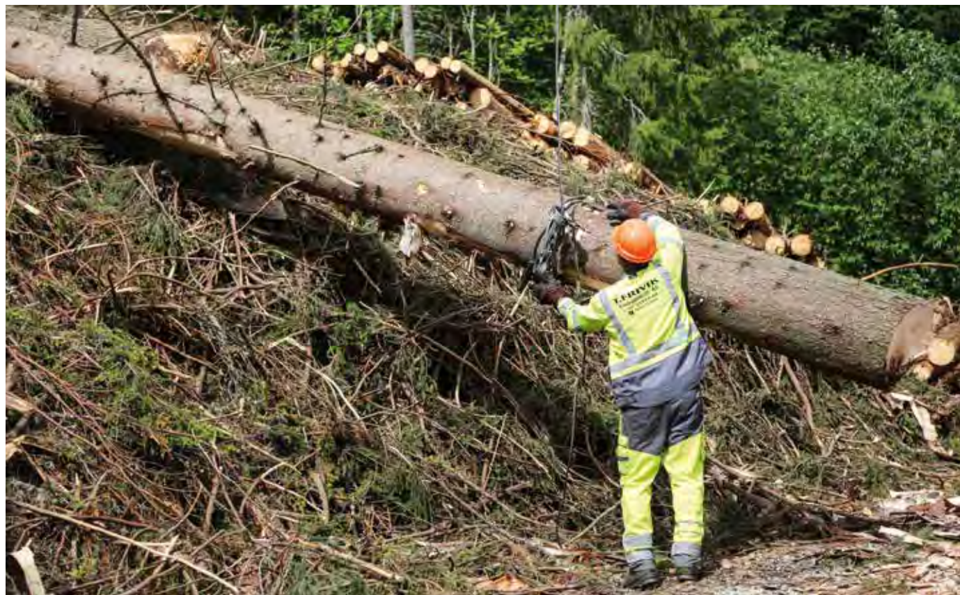
TRE MANN: Frivik driver konsekvent med tre mann og én maskin. En mann sørger for den manuelle hogsten, en annen stropper tømmeret fast i stålwiren og sender det, ved hjelp av den fjernstyrte løpekatten, helt ned til der krana står, hvor en tredje person tar seg av kvisting, kapping og lasting på bil for transport.
