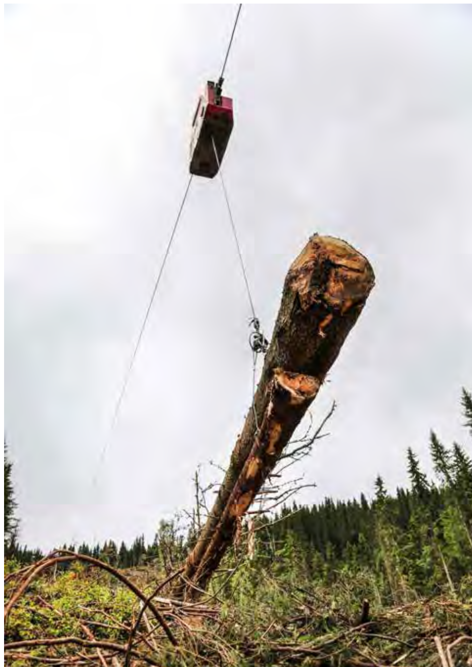
KREFTER: Når tømmeret befinner seg midt i et langt strekk, setter store krefter inn. Frivik forankrer for 18-20 tonns press på kabelen (en 22 mm spesialkabel).
