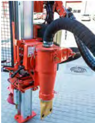
PRE-SYKLON: Dino har også fått pre-syklon, for å sortere ut større fragmenter.
