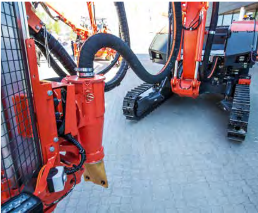
PRE-SYKLON: Dino har også fått pre-syklon, for å sortere ut større fragmenter.
