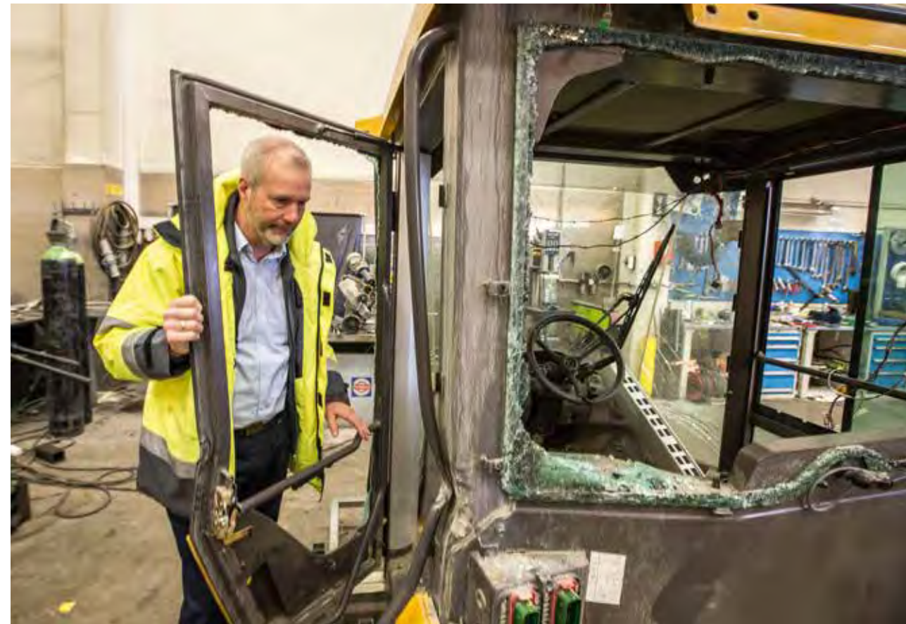
ADVARER: Knut Sollesnes i MGF og Volvo Maskin advarer mot at CE-merking blir ugyldig ved reparasjon av strukturen i ROPS-hytter.
