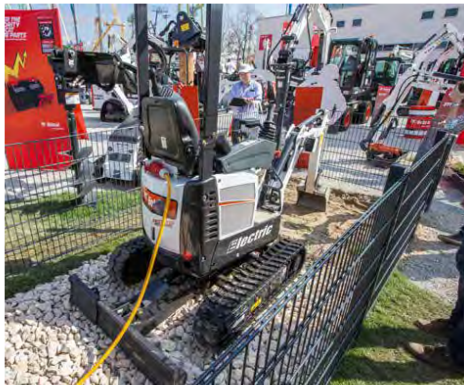
SMÅTT: Det finnes elektriske gravere. Men de kan ikke grave ut en sykehjemstomt. Dette er prototypen på Bobcats nye oppladbare 1000-kilos minigraver. (ALLE FOTO: JØRN SØDERHOLM)
