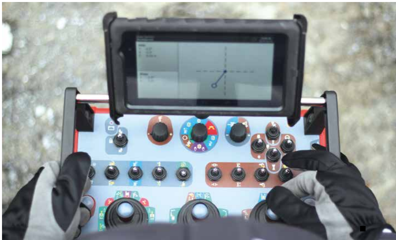
SKJERM: Operatøren får informasjon om boringen til en skjerm på kontrollpanelet i stedet for på selve riggen.
