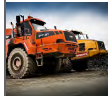
Veidekke-dumpere som disse, fra byggingen av Riksvei 2/E16 mellom Kongsvinger og Gulli, er blant maskinene som nå MÅ ha rygge-kamera. (Foto: VEIDEKKE).
