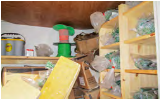
SAMLAGRING: Er det minst én meter mellom sprengstoff- og tennerlager? Her er det til og med et 12 V batteri i samrøret. (ALLE FOTO: STENSVIK/KVILTEN/DSB)
