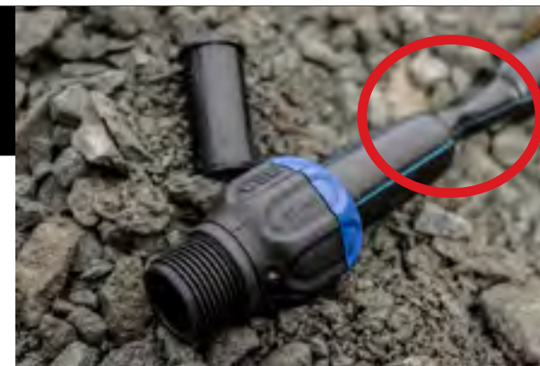
STØTTEHYLSE er viktig. Her er røret test-trukket med koblingen på. (FOTO: ISIFLO)
