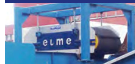
Magnetseparator MS1000S1200 Separering av järn
