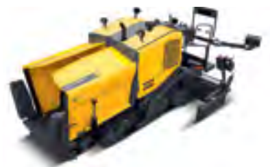
KOMPAKT: Dynapac F1200C legger asfalt fra 0,3 til 3,1 meters bredde.
