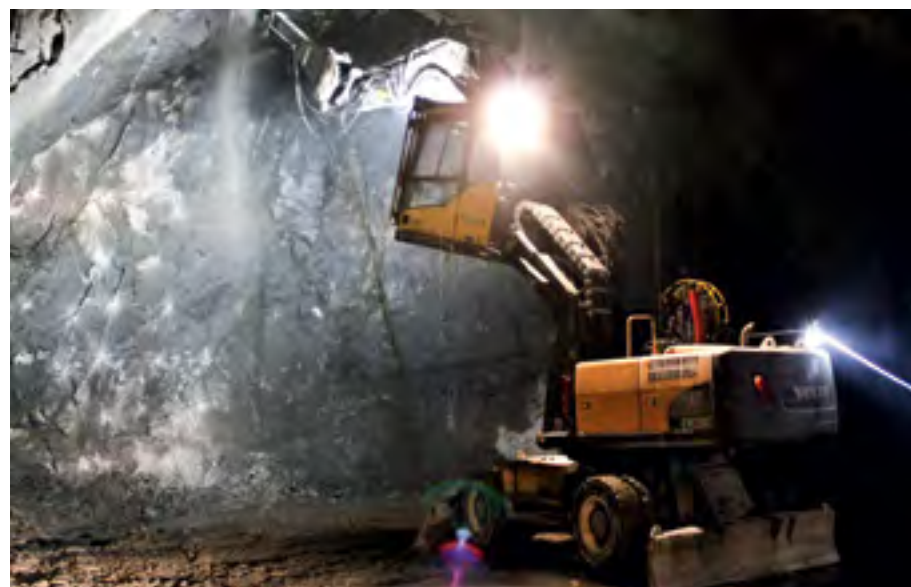
TUNNELRENSK: Med hev-, senk- og tiltbar hytte, kan maskinføreren nærmest ligge og renske oppe i tunneltaket. (FOTO: VOLVO MASKIN).
