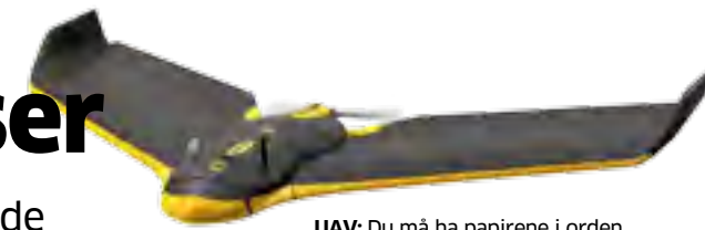
UAV: Du må ha papirene i orden før du hiver UAV-en til værs for å måle anlegget. Dette er en Sensefly Ebee.
