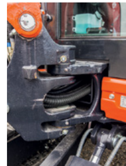
FORING: Bolt i foring i stedet for rett i godset på bominnfestingen er bra for vedlikeholdet.
