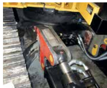
FESTE: Skjær og braketter ble hentet fra en Cat 314. Monteringen tok 40 timer. (FOTO: PON EQUIPMENT AS)
