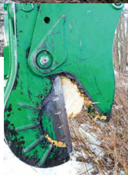
KNIV: Kutteren på 005-modellen tar trestammer inntil 25 cm.
