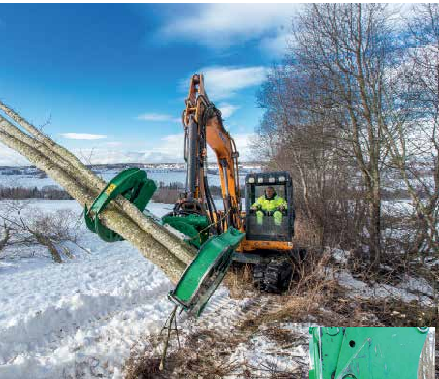
FELLING: WT trefelleren er et hendig verktøy for felling og rydding av skog. (FOTO: JØRN SØDERHOLM)
