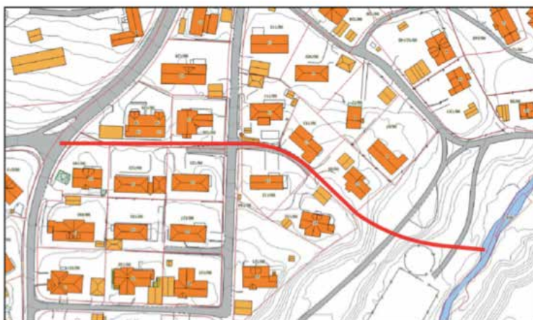
PLAN: Boretraséen snor seg gjennom boligfeltet. Den forserer en høydeforskjell på 16 meter, med største dybde åtte meter.
