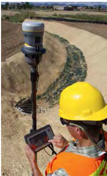
KAMERA: 12 kameraer tar 360 graders bilder. Kombineres med totalstasjon eller GNSS-mottaker.
