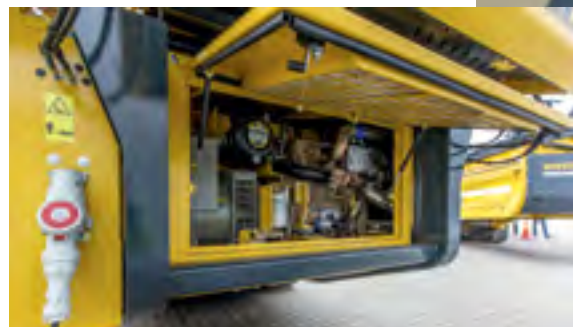
HYBRID: Dette er motoren på et Frontier sorteringsverk. Den kan også levere strøm til å drive nabomaskinen.
