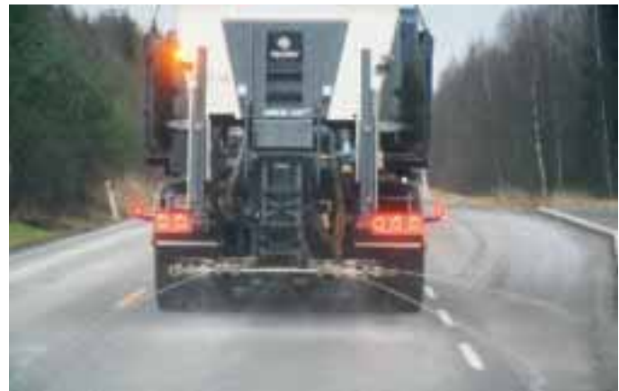
Praktisk prøve Eksempel på sanntids gps-styring av dyser i ferd med å sende salt inn i en busslomme langs en av de to testrodene i Akershus.
