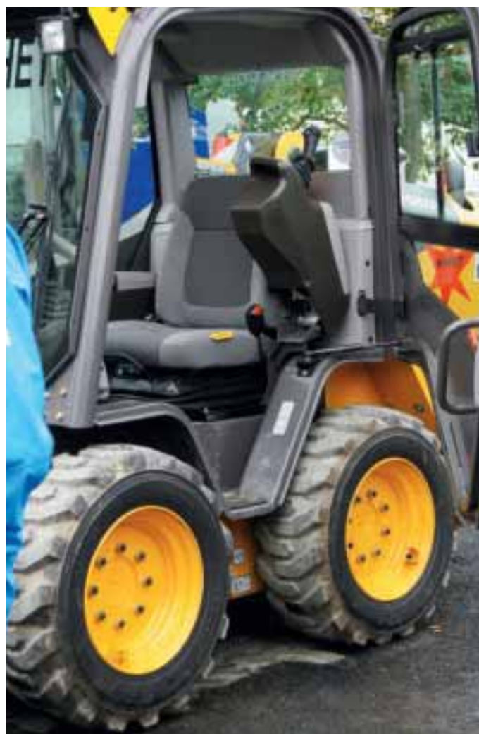
JCB-kloning Nye Volvo MC60 har sidehengslet dør og enkel lastearm, nøyaktig lik JCB 225 kompaktlastar.
