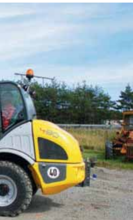
STYRING: Maskinen har styring på alle fire hjul, ikke midjestyling. Det har sine fordeler, men krever også sine hensyn.
