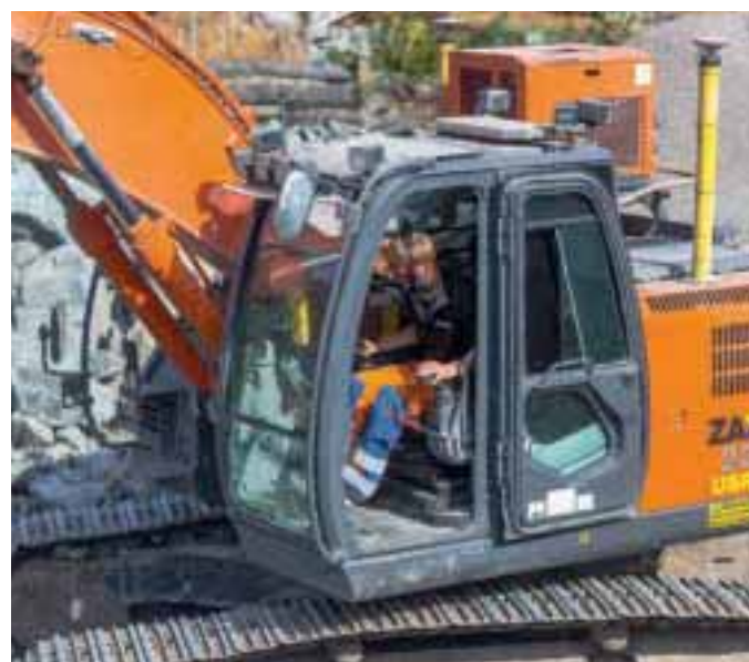
TOMT: Steinrøysa skal bli en tomt til en firemannsbolig. Bak hytta er det montert en kompressor til boretårn.
