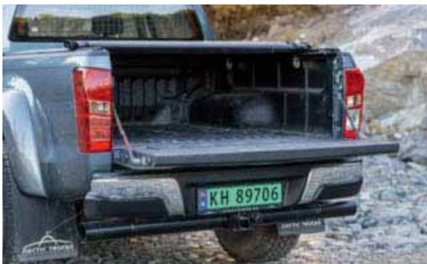
KASSE: Lasteplanet er kledd med Vortex belegg. Et godt alternativ til innvendig plastkasse.
