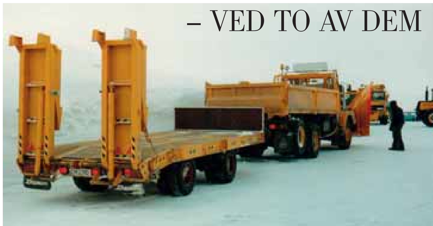
Til maskiner 12-tonns GMV maskintransporthenger fra 1973.
