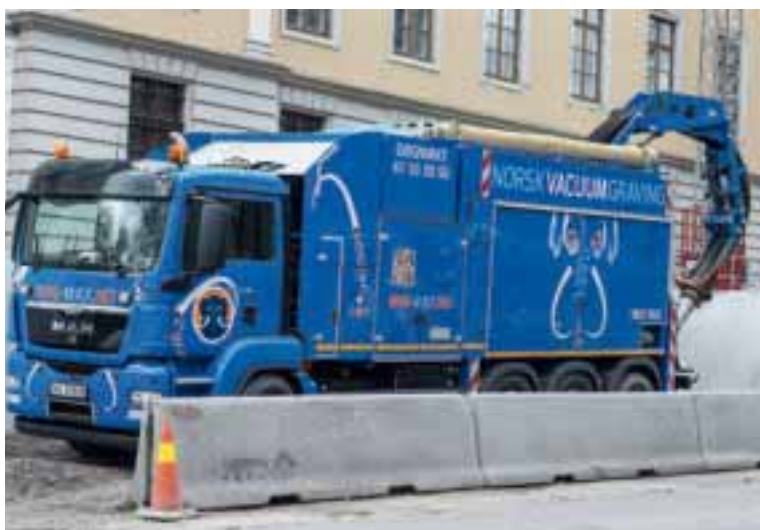
MAN TGS 480, fireakslet chassi. Påbygget kommer fra tyske Mobile Tiefbau Saugsysteme.
