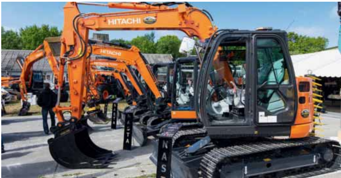
NY: Hitachis ZX 85 har blitt spesielt tilpasset bruk med HK-feste og rototilt.
