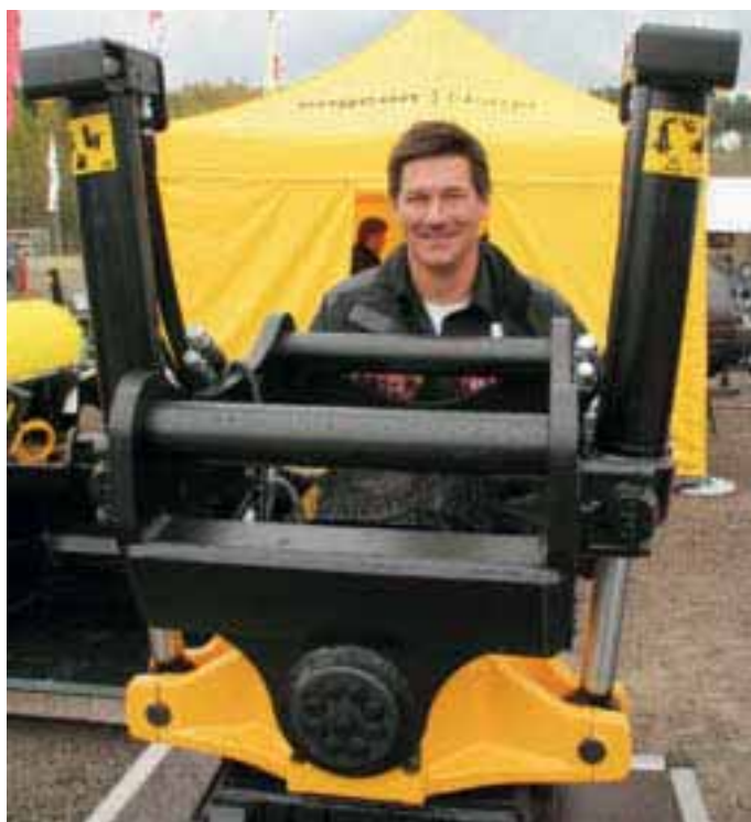
Smørbar Stig Engstrøm med Engcons nye serie tiltrotatorer klargjort for sentralsmøring.
