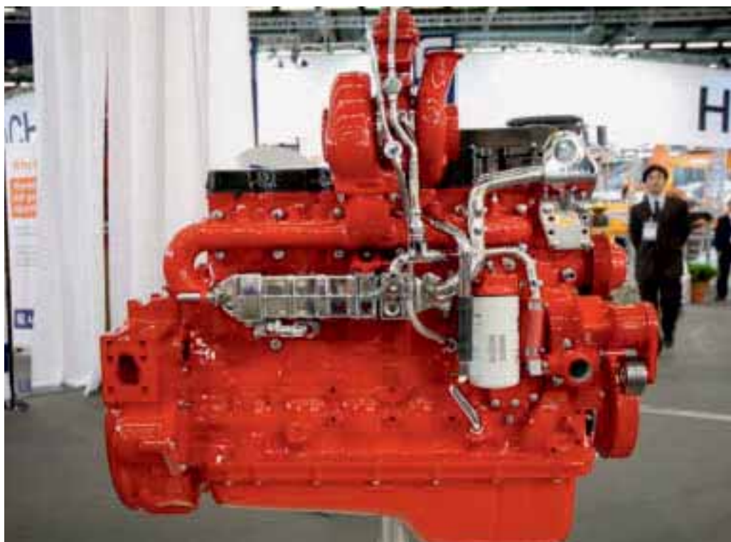
SCR-metoden Cummins er storleverandør av motorer til flere produsenter av anleggsmaskiner. StegIIIB-motorene benytter såkalt selected catalytic reduction-metode.
