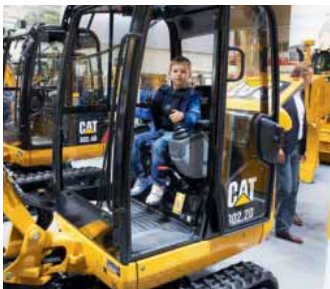
STØR: 302-2D er Cats største med hydraulisk breddbart understell.
