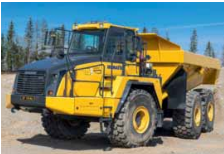
BREMSER: Dumperen HM 400-3, med oljekjølte lamellbremseser.
