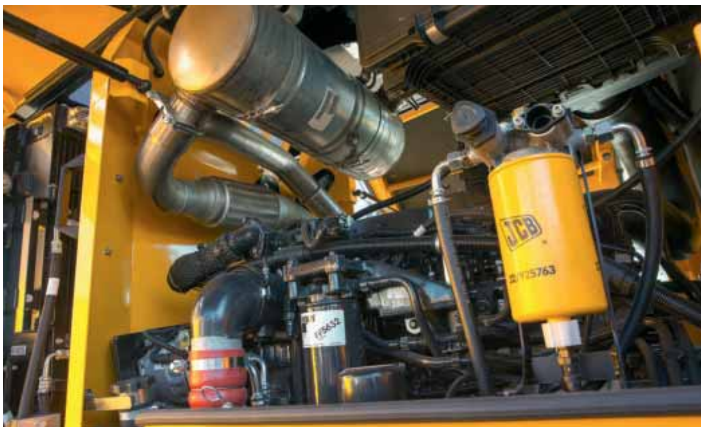
FILTER: Motorrommet i 427. Dieselpartikkelfilteret øverst.
