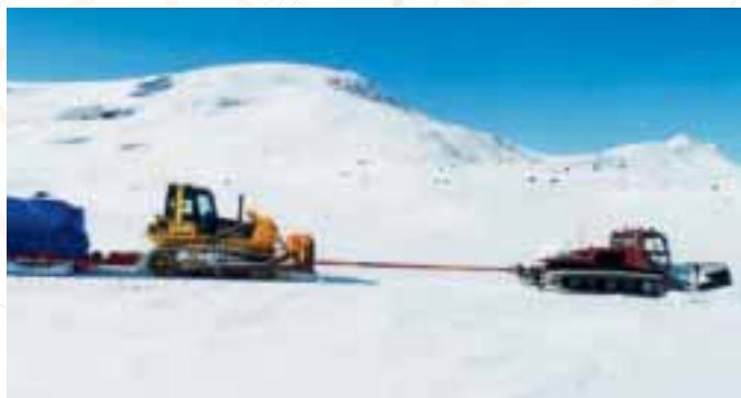
Flotte forhold, tross minus 26 grader. På de vanskeligste etappene ble det brukt tråkkemaskin foran bulldoser til styring og drahjelp.
