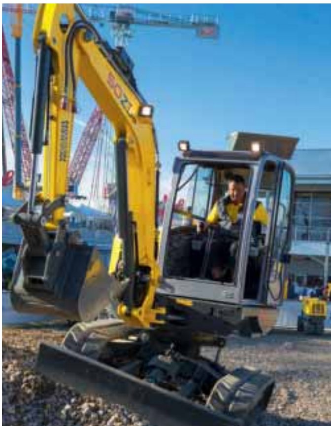
TILT: Wacker Neusons VDS-system reduserer livet på skråplanet. Dette er korthekkeren 50 Z3.
