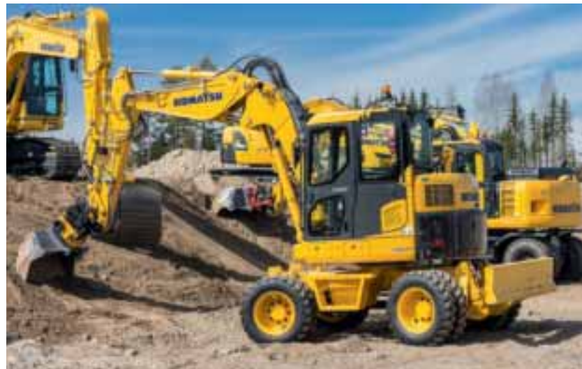
SVINGER: Hjulgraveren PW 98 kan styre på alle fire, og er nøysom med plassbehovet.
