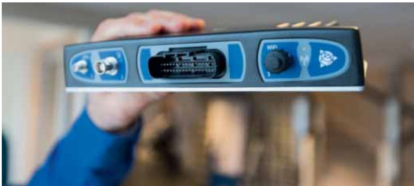
LINK: Dette er Vision Link, Trimbles boks for trådløs forbindelse til maskinstyringen.
