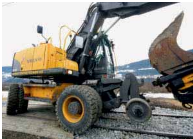
Sikker Volvo EW160C-graveren har alt av utstyr som må til for å være godkjent av Jernbaneverket for skinnedrift.
