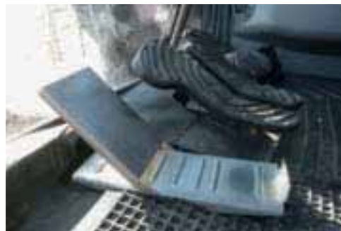
Tilpasset Med denne pedalen styres bomløftet på den ombygde Volvo-graveren.
